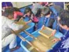
「すき槽」の中に原料を入れ、とろろあおいの根から取り出した粘液を加えます。原料繊維を均一に分散させながら、すげたで、一枚一枚紙をすきます。
